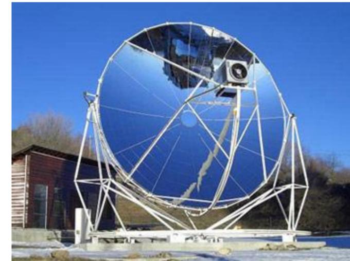
Figure 29 : Module "parabole-Stirling" d'Odeillo
